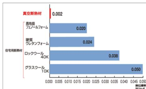
断熱性能を同じにした時の厚みの比較
