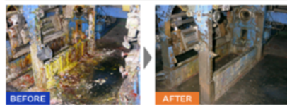
ワイヤコンベヤーに付着した炭化物と錆び
