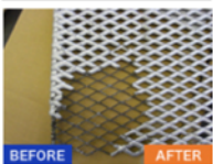
塗装治具（網）に付着した塗料
