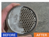
射出成形機（ブローカーブプレート）に付着した樹脂
