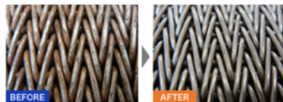
ワイヤコンベヤーに付着した炭化物と錆び
