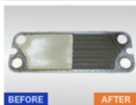
熱交換プレートに付着した各種汚れ
