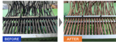
設備に付着した油と錆び
